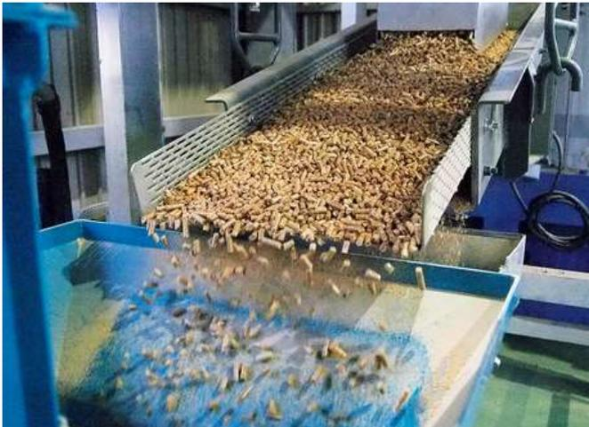
乾燥させたチップをさらに粉状にしてペレット成型機へ送ります。木に含まれる成分リグニン等が接着剤となり、木粉が直径約0.6センチ、長さ約2センチのペレットになります。
