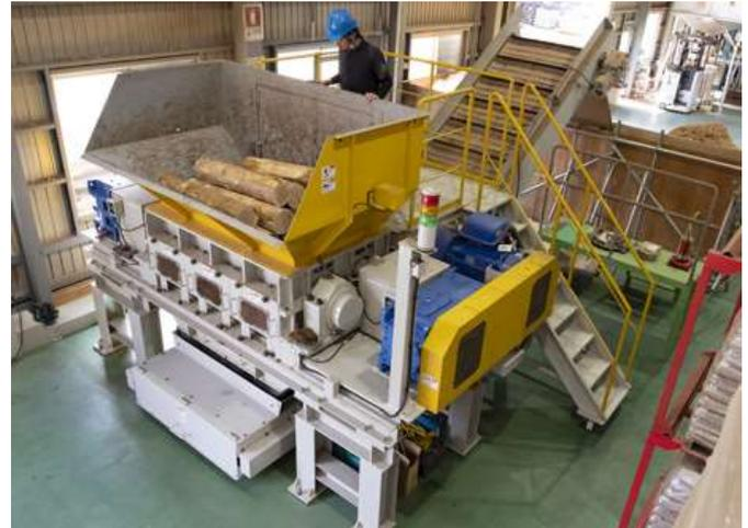
森林から伐り出されたスギ・ヒノキ・サワラの間伐材や林地残材を自社工場に集積し、樹皮を剥いて(ホワイトペレットのみ)から破砕機で細かくチップ状に加工します。
