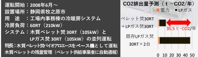
世界初木質ペレットを直接燃料とした冷暖房機器「木質ペレット焚きバイオアロエース」がCO<sub>2</sub>削減に大きく貢献します。
